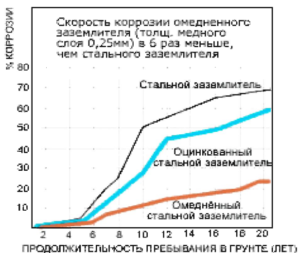
Рис. 3. Антикоррозийная устойчивость заземлителей
